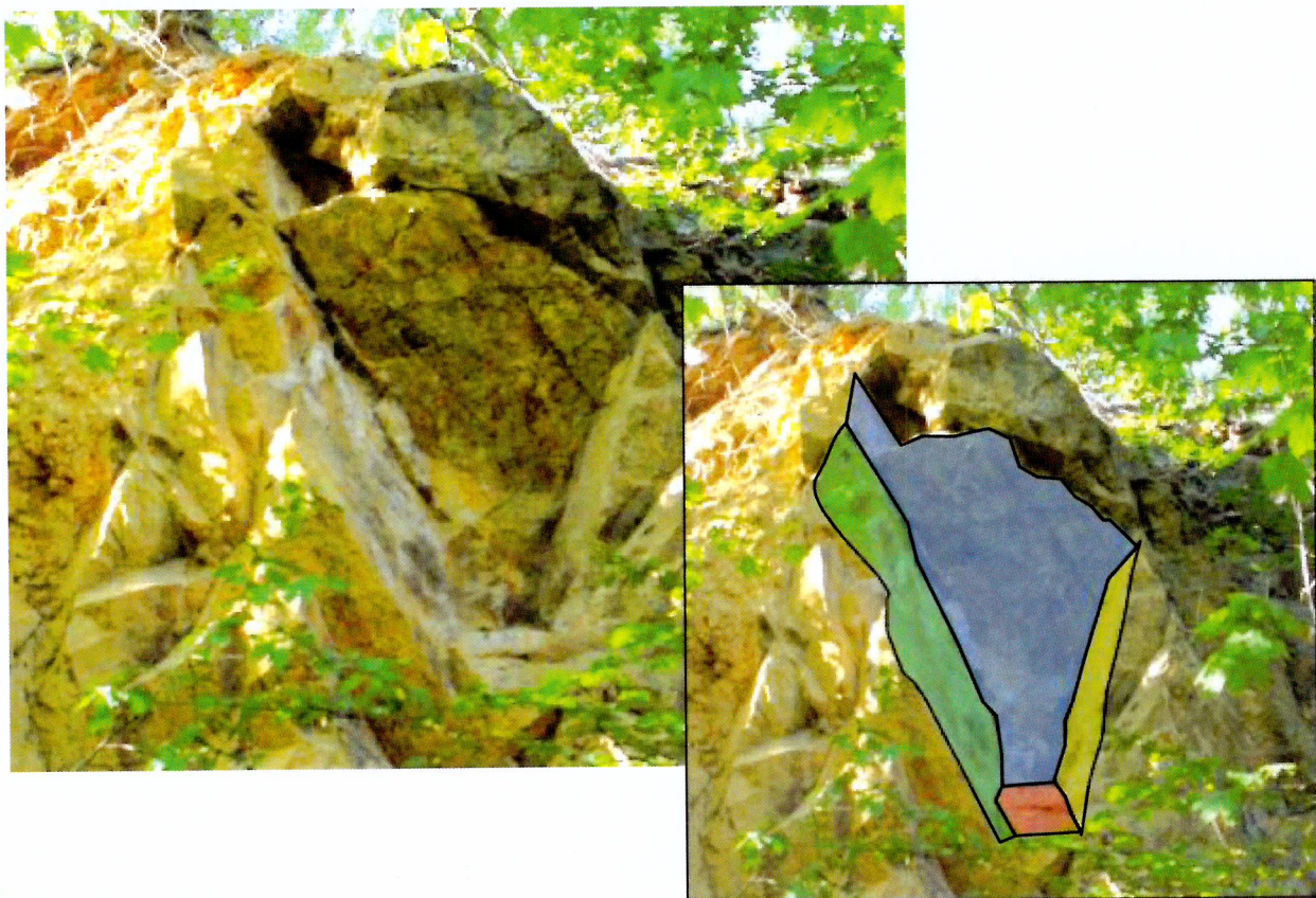
Obr. 5 Vyznačení ploch nespojitosti, podle kterých dochází k rozpadu hornin skalního podkladu na bloky kvádrotitého až lavicovitě deskovitěho habitu
