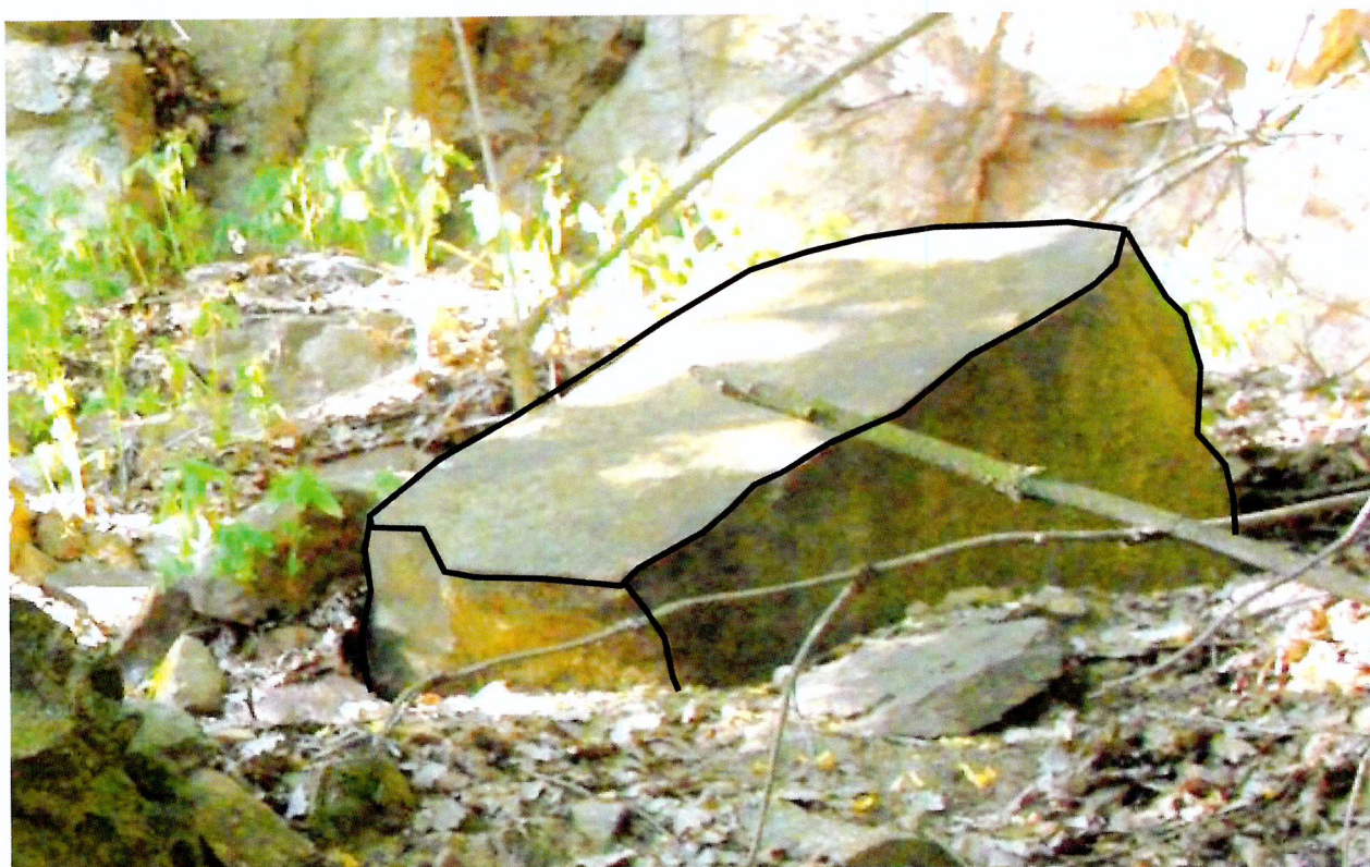
Obr. 6 Charakteristický tvar uvolněných bloků (kvádrotitý až lavicovitě deskovitěho habitus)
